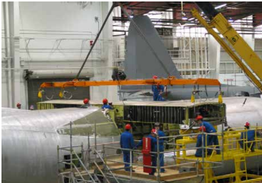
Figure A-3 Positionnement de la voilure centrale d'un C-130
