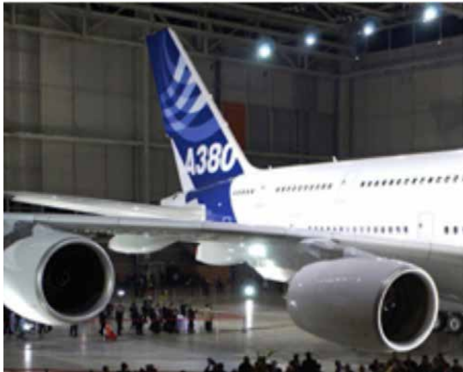
Figure B-5 Moteurs montés sur des pylônes
