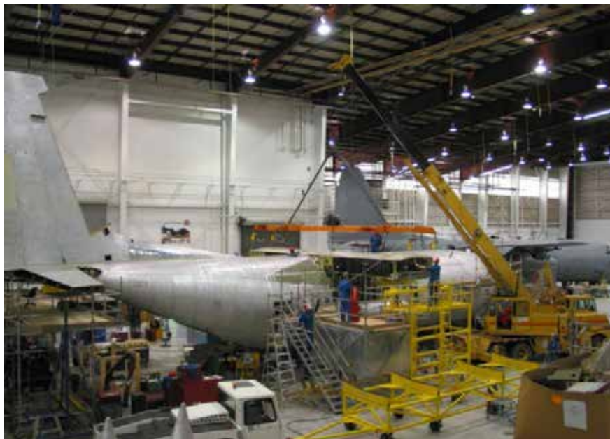
Figure A-2 Mise en place de la partie centrale de la voilure d'un C-130
