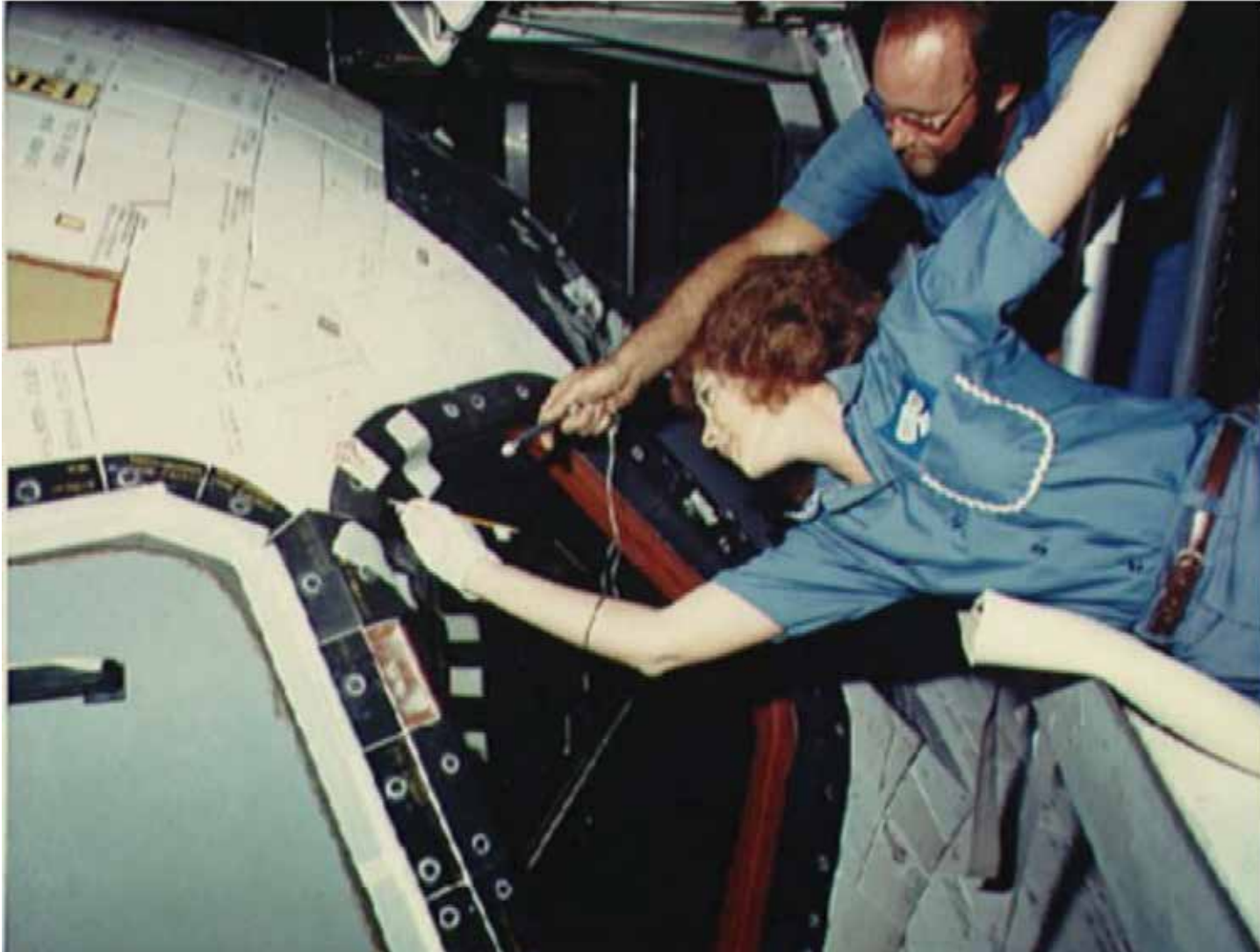
Figure B-3 Réparation du système de protection thermique de la navette Columbia
