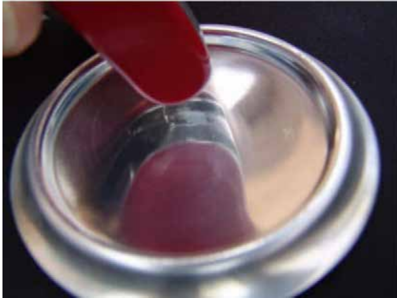
Figure 5 Vérification du polissage
