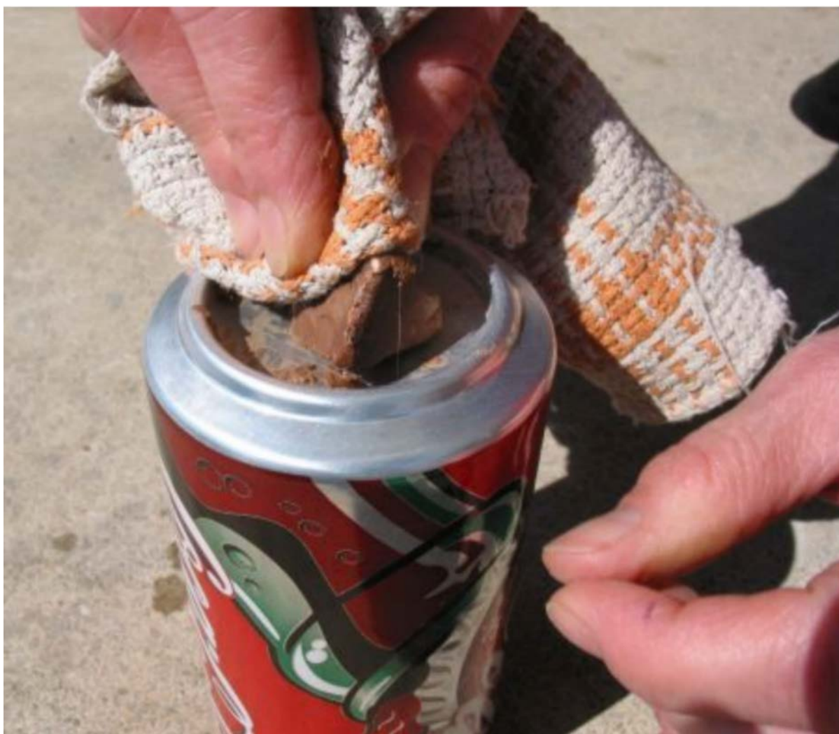
Figure 4 Polissage de la base d'une canette d'aluminium
