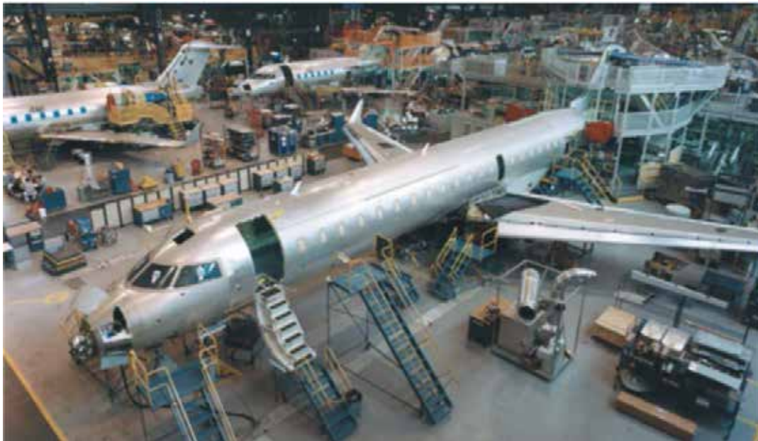
Figure A-10 Chaîne de montage du CRJ700 de Bombardier
