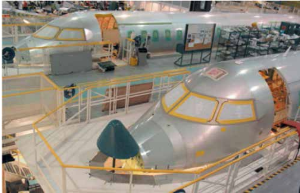
Figure A-9 Assemblage du fuselage d'un CRJ700 de Bombardier
