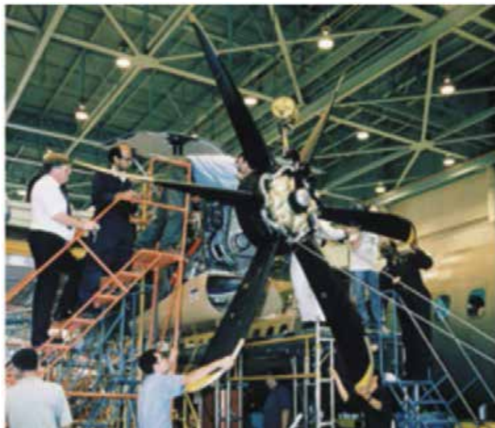
Figure A-8 Assemblage du moteur d'un QR 400 de Bombardier
