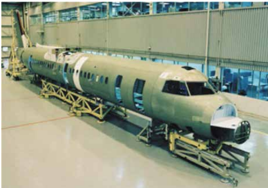
Figure A-4 Assemblage du fuselage d'un QR 400 de Bombardier
