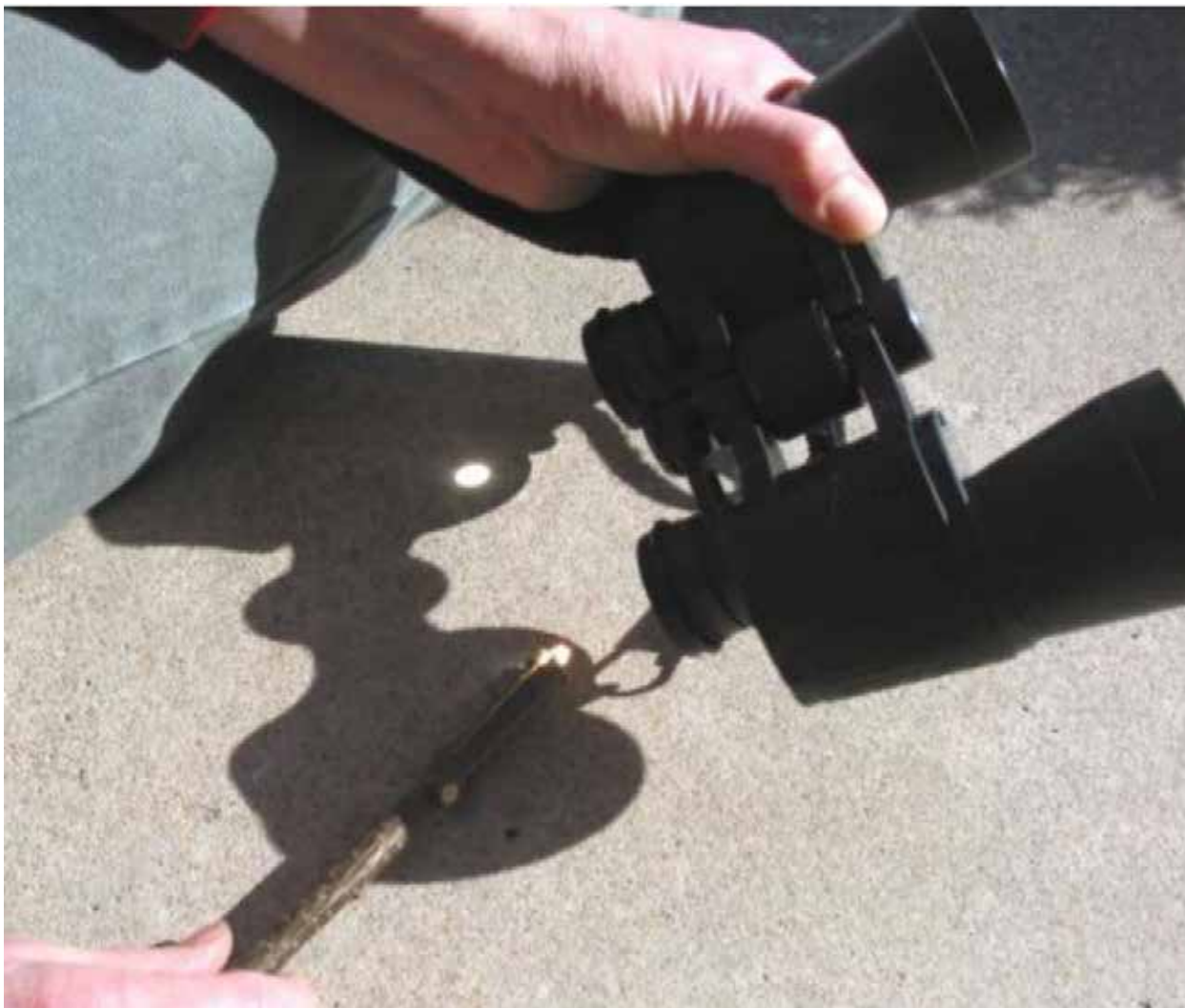
Figure 12 Allumage d'amadou au moyen de jumelles
